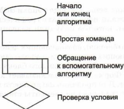
Рис. 1.8. Элементы блок-схем и структура «цикл»
