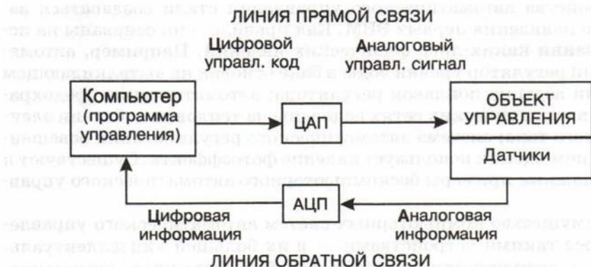
Рис. 1.15. Схема системы автоматического управления
