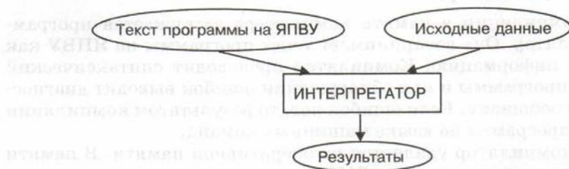
Рис. 2.20. Выполнение программы на ЯПВУ с использованием интерпретатора
