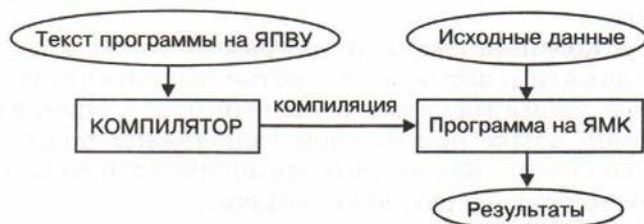
Рис. 2.19. Выполнение программы на ЯПВУ с использованием компилятора
