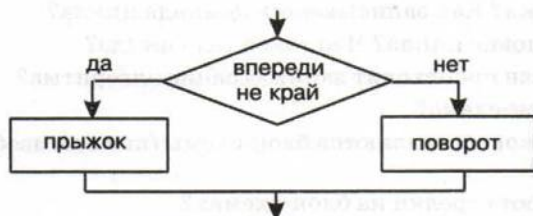
Рис. 1.11. Блок-схема полного ветвления
