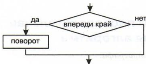
Рис. 1.12. Блок-схема неполного ветвления
