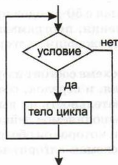
Рис. 1.8. Элементы блок-схем и структура «цикл»
